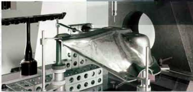
La mesure de pièces à symétrie de révolution et de pièces comportant des formes amorphes – telles que pièces en tôle d'acier – est facilement réalisable avec les machines de la série PMS.
