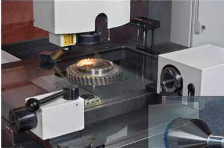
Un bloc de support constitué d'une poupée porte-pièce (comportant une broche rotative) et d'une contre-poupée est disponible en option – intégré en tant qu'axe à commande numérique par ordinateur (CNC) réglable en continu et doté d'interfaces standard ou personnalisées en fonction des besoins spécifiques du client, ce qui assure un large éventail de possibilités de mesure.
