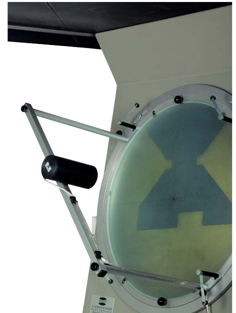
Option: dispositif de documentation avec camera CCD pour consigner la qualité
