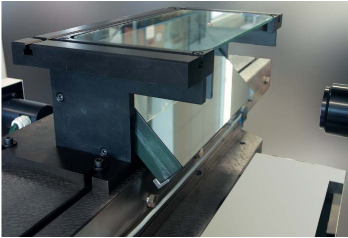
Plateau particulier pour la mesure de profils très minces sur un projecteur de mesure horizontal
