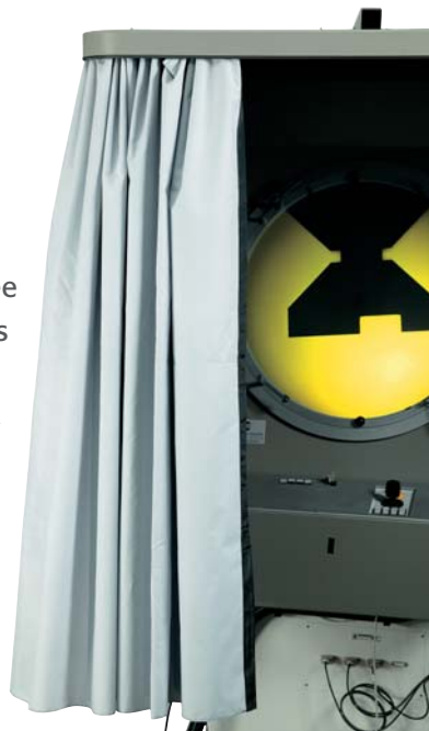
Rideau d'obscurcissement, particulièrement nécessaire pour la mesure avec lumière incidente ou en cas de fort agrandissement
