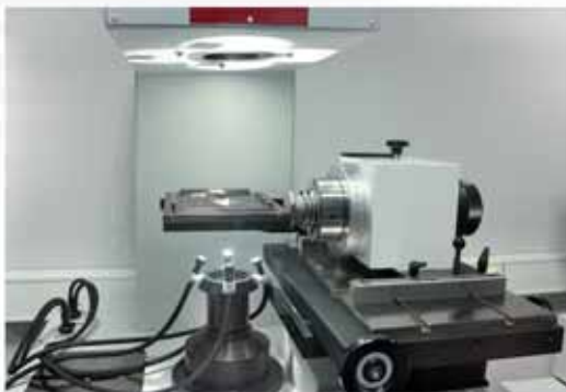
colonne latérale avec mandrin SK50 à rotation manuelle pour la mesure d'outil de grand diamètre. Une table en verre avec mandrin SK50 est disponible sur demande
